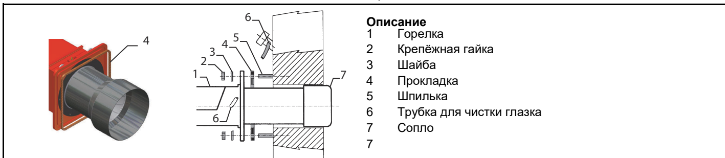
Рис. 5 Монтаж горелки на котле
