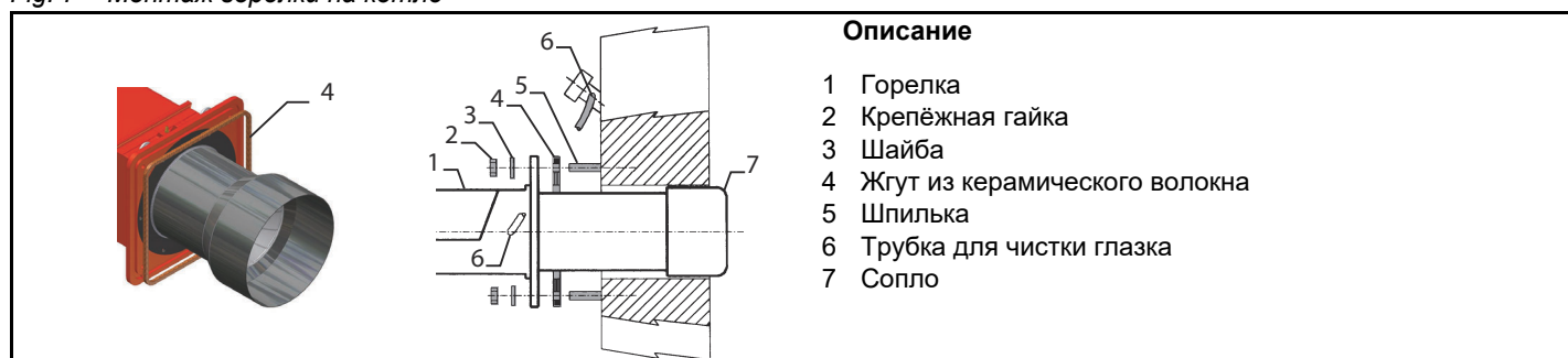
Fig. 7 - Монтаж горелки на котле
