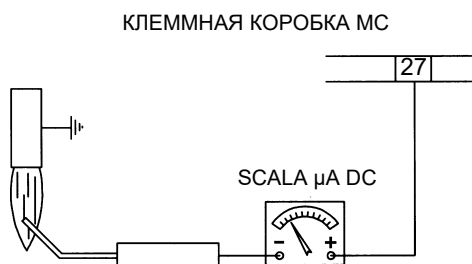
Рис. 9 - Контроль пламени с помощью электрода
