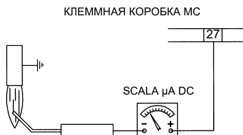
Рис. 9 - Контроль пламени с помощью электрода
