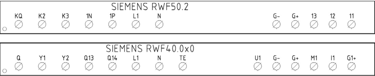
Соответствия клемм между модуляторами RWF50.2 и RWF40.0x0
