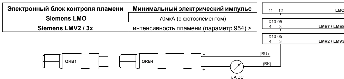
Обнаружение с помощью фотоэлемента QRB4 - QRB1
