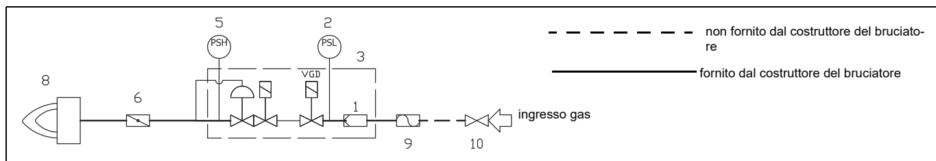
Rampa con gruppo valvole VGD con stabilizzatore di pressione gas incorporato
