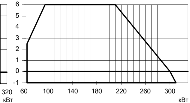
LG280 Двухступенчатое - Прогрессивная
