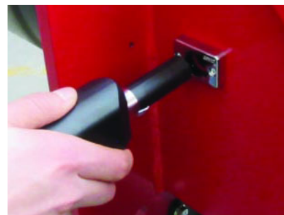
Рис. 17 - Контроль пламени с помощью фотоэлемента QRA.
