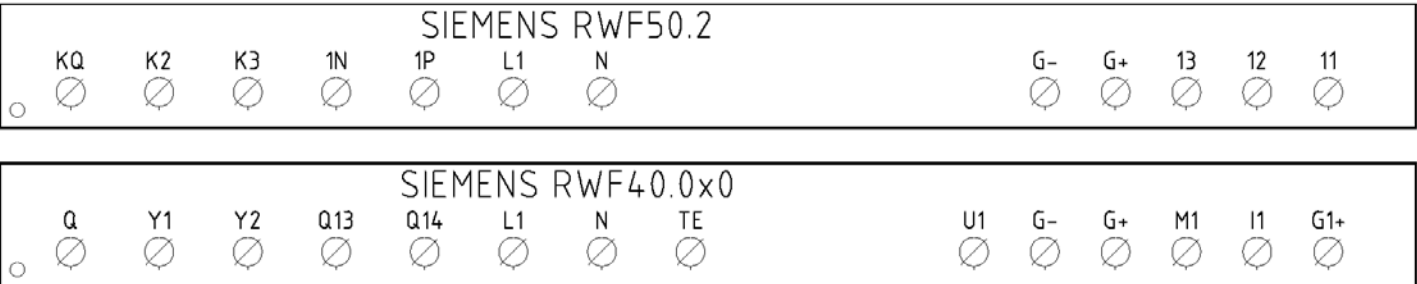
Соответствия клемм между модуляторами RWF50.2 и RWF40.0x0
