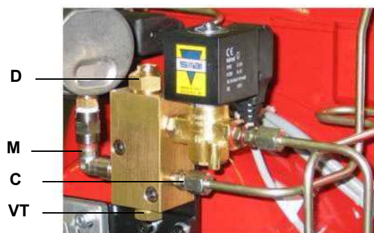
Рис. 22 - Ручной регулятор жидкого топлива
