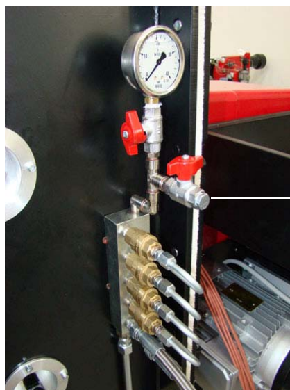
вход сжатого воздуха
