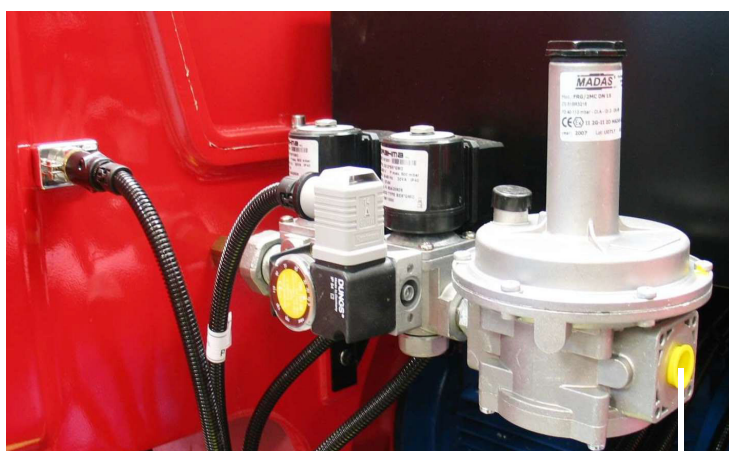
подсоединение к сети распределения газа - 1/2"
