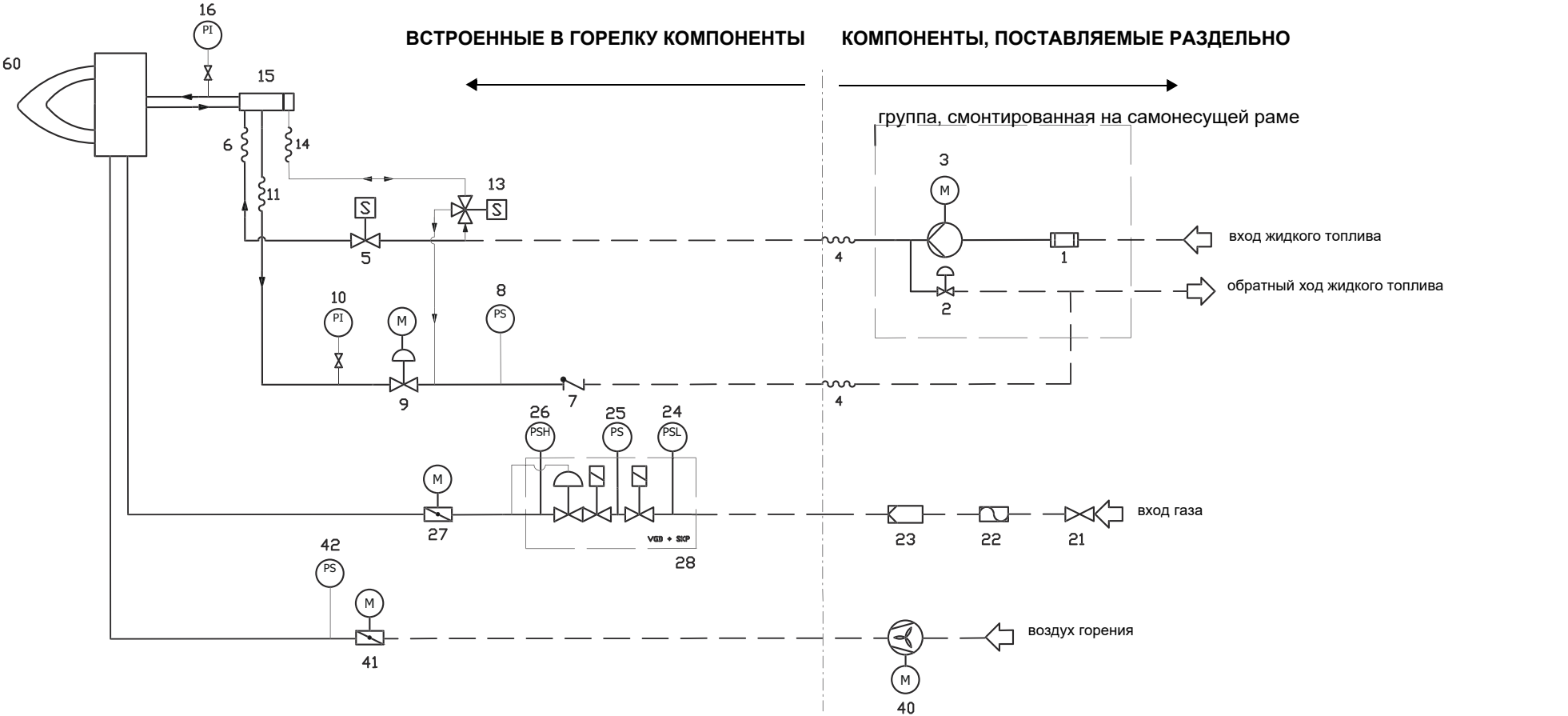
Рис. 4 Гидравлическая схема 3I2MG73 v0
