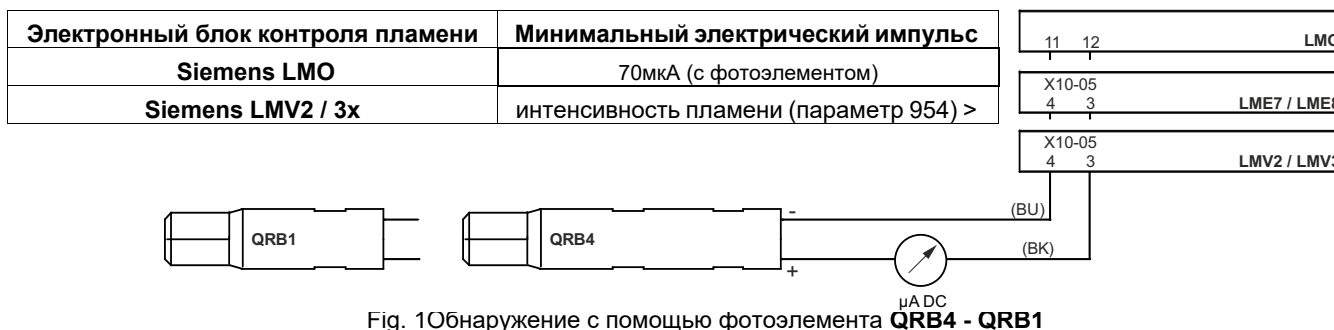
Fig. 1Обнаружение с помощью фотоэлемента QRB4 - QRB1
