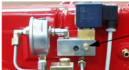
Fig. 14 - Distribuidor gasoleo (PG60)
